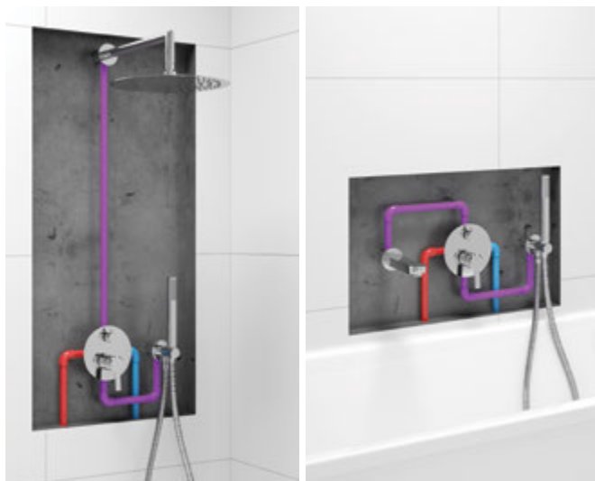
BATERIA PODTYNKOWA Z PRZEŁĄCZNIKIEM FUNKCJI / CONCEALED SHOWER TAP WITH SHOWER SWITCH
